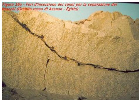
Figura 16a - Fori d'inserzione dei cunei per la separazione dei blocchi (granito rosso di Assuan, Egitto)
