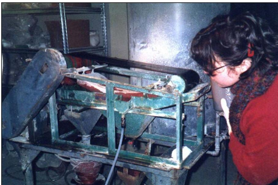
Figura 6.b: foto separatore modello HMS LAB, presso l'impianto della Minerali Industriali
