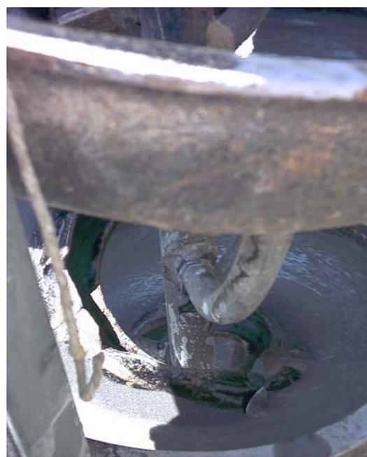
Figura 16: separazione idrogravimetrica con spirale a regime
