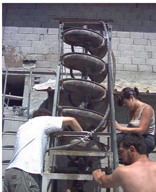
Figura 15: regolazione delle "coppelle sagomate" di prelievo del prodotto pesante.
