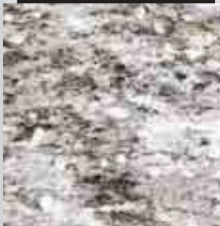
**Fiammata** - utilizzando il cannello ossidrico ed il repentino raffreddamento ad acqua si provoca la scagliatura della superficie con un ottimo risultato estetico peraltro fortemente antiscivolo.
