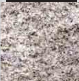
**A spacco** - ottenuta con la semplice azione meccanica che agisce sulla separazione geologica dei materiali.
