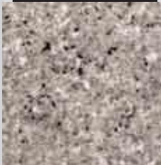
**Levigata** - ottenuta anch'essa con passaggi abrasivi limitati ad ottenere una superficie liscia, ma porosa particolarmente utile contro lo scivolamento
