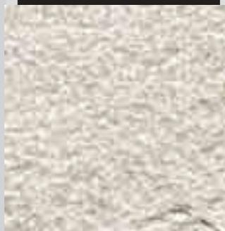
**Bocciardata** - ottenuta con la tecnica della percussione sulla superficie. E' una lavorazione storica impiegata nelle strutture classiche o ad esse ispirate.
