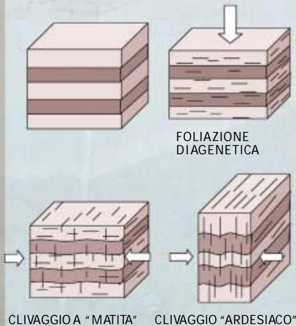
ESEMPIO DI STRATI PIEGATI, IN CUI SI È FORMATO UN CLIVAGGIO DI PIANO ASSIALE
